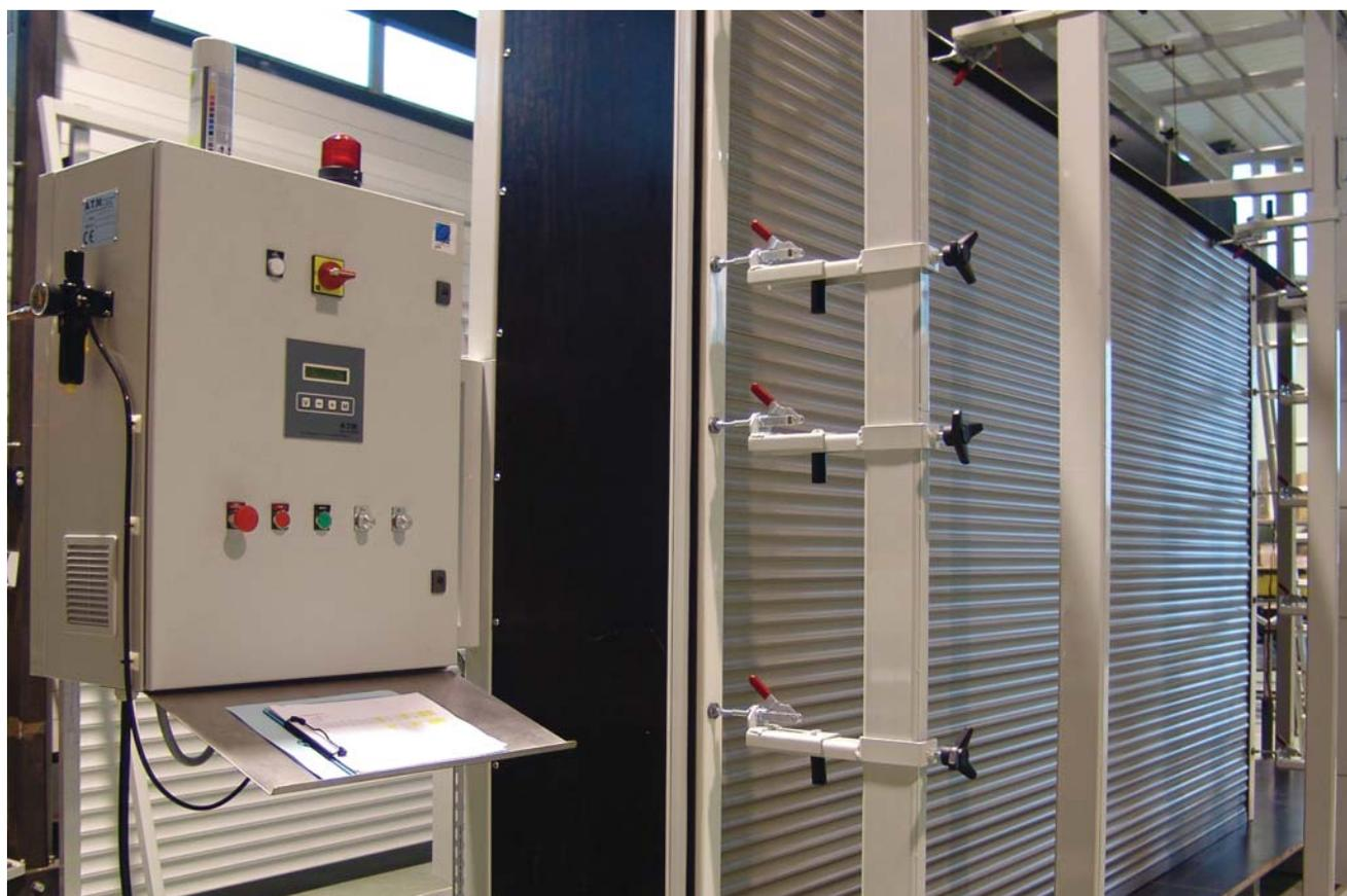
el ámbito del cerramiento, dispone de un equipo de ensayos certificado para la realización de las pruebas de resistencia a la carga de viento según norma UNE-EN 1932, así como personal técnico especializado en su uso, de forma que se han podido clasificar satisfactoriamente todos y cada uno de los perfiles de persiana fabricados por la empresa, para todos los anchos útiles y diferentes tipologías de guías instaladas normalmente tanto en España como en el resto de la Comunidad Europea.
